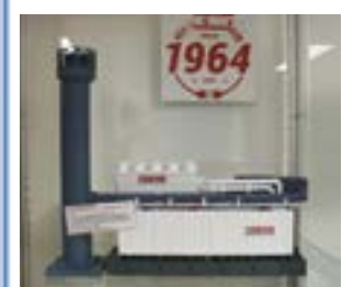
Modell einer großen Netzersatzanlage der Firma FRERK-Aggregatebau
